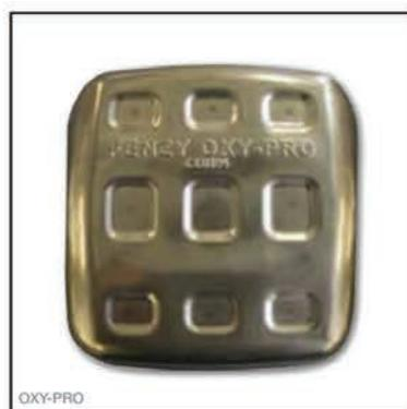
Oxy-Pro potasyum superoksit ( $KO_2$ ) ten solunabilir hava üretmesi sayesinde uzun kullanım süresine sahip olan bir kimyasal oksijen acil kaçış cihazıdır. EN 13794 Avrupa standartlarına uygundur. Kapalı ve dar alanlar gibi yüksek riskli çalışma ortamlarından acil kaçış durumda kullanılması önerilir.
